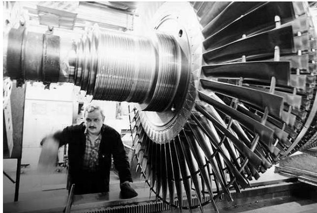
Fig. 1. Turbina de vapor industrial.
