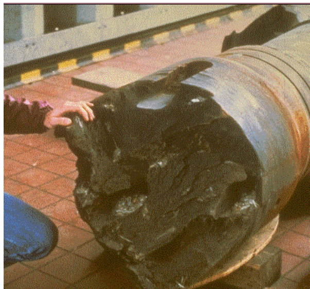
Fig. 1-1 Rotor fracturado con grieta transversal.
