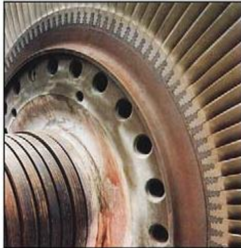
Fig. 1-2 Rotor de una turbina con grieta transversal.
