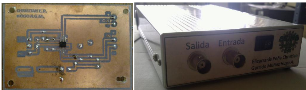
Figura 2.1 Amplificador de bajo nivel de ruido, con ganancia de 60 dB y ruido en voltaje de 1 \times 10^{-18} \text{ V}^2/\text{Hz} y ruido en corriente de 4 \times 10^{-24} \text{ A}^2/\text{Hz}
