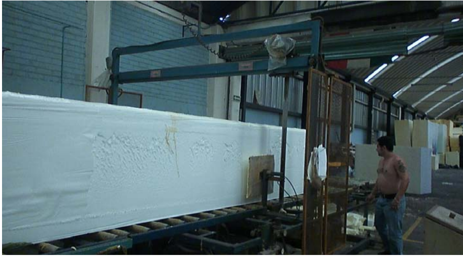
Figura 2.7. La máquina cortadora en color gris se muestra con dos líneas paralelas por encima de la barra de espuma en blanco.
