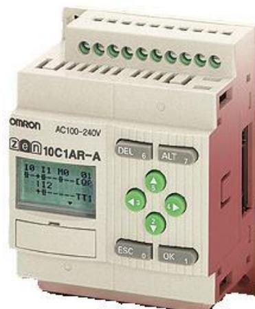
Figura 3.7 Ejemplo de PLC tipo nano.
