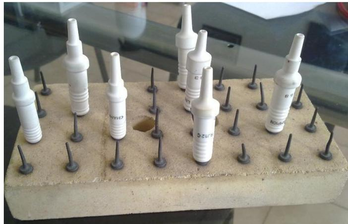
Figura 2.5 Base con bujías para horneado.
