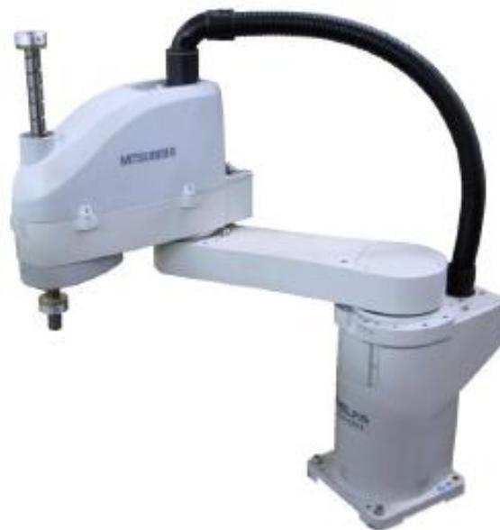
Figura 3.13 Robot SCARA RH-6H.
