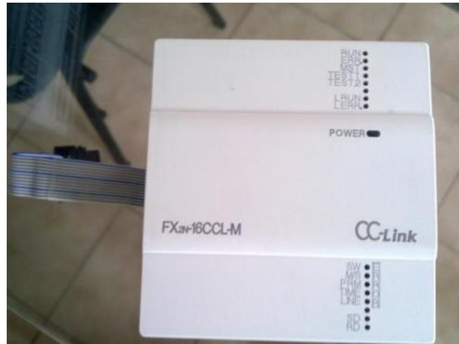
Figura 3.25 Modulo máster para comunicación CC-LINK.
