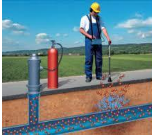
Figura 1.12. Aplicación del método de detección usando gas.
