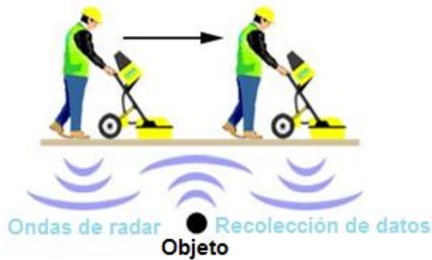
Figura 1.13. Funcionamiento del radar subterráneo.
