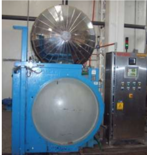
Fig. 1.2 Tablero eléctrico con HMI y PLC
