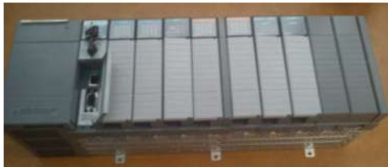
Fig. 3.2 PLC utilizado en el tablero de control Autoclave.
