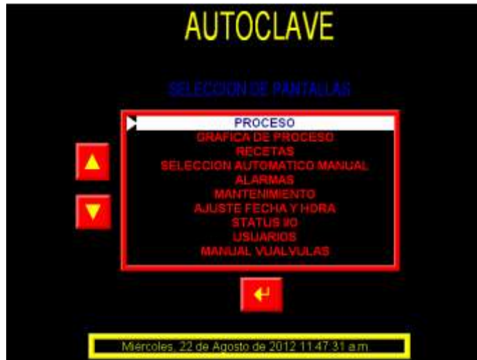
Fig. 3.27 Pantalla principal en HMI de la Autoclave.
