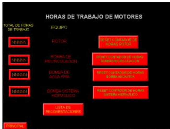
Fig. 3.47 Pantalla de HMI Horas de Trabajo de Motores de la Autoclave.
