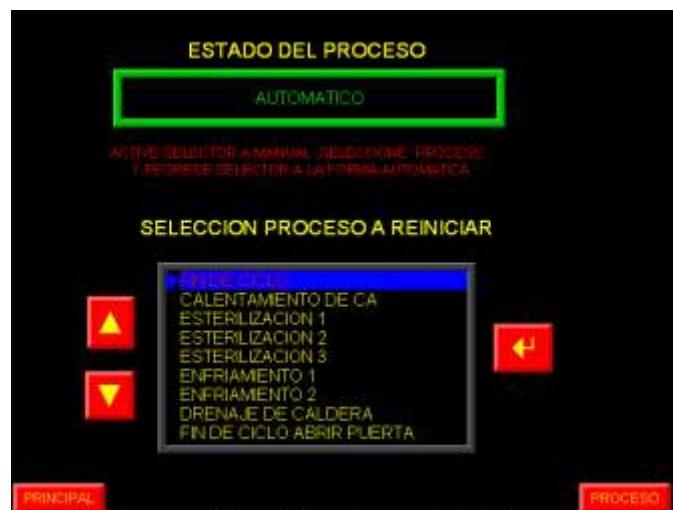
Fig. 3.35 Pantalla de HMI Manual/Automático de Procesos de la Autoclave.
