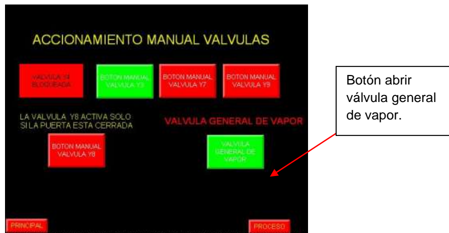
Fig. 3.28 Pantalla de HMI accionamiento manual valvulas de la autoclave.
