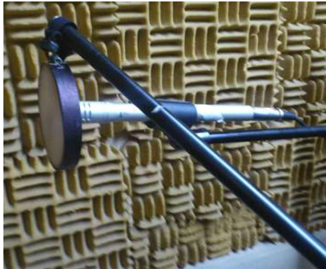
Figura 32 Instalación micrófono SM81 con anti pop
