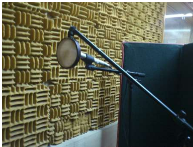
Figura 33 Adaptación de materiales absorbentes alrededor del Micrófono sm81, donde se realizara la grabación de diálogos y sonidos incidentales
