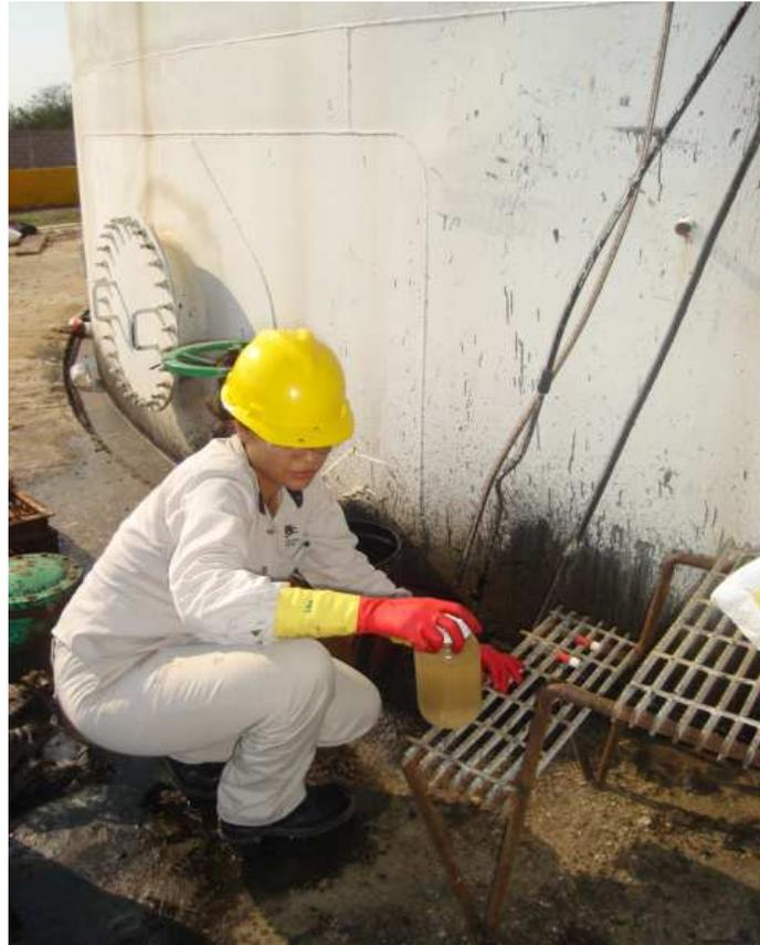
**Figura. 4.10** Recolección de una muestra para grasas y aceites en el tanque deshidratador TGB-163
