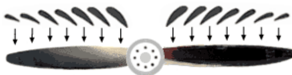
Fig. 2.5.- Perfiles y ángulos de incidencia
