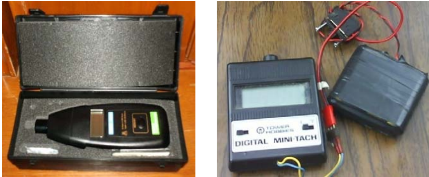
Fig. 6.20.- Tacómetros ópticos utilizados en las pruebas
