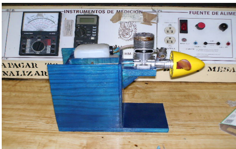
Figura 6.12.- Bancada, motor, hélice, depósito de combustible y servo
