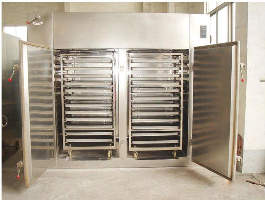
**Figura 2.1 Secador Convectivo de bandejas convencional**
