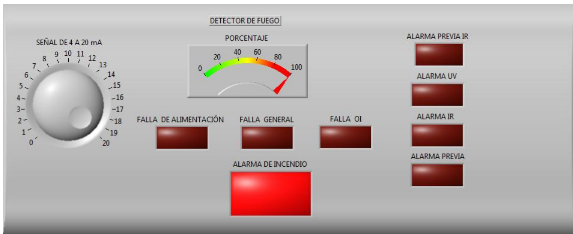
Figura 4.7. Interfaz gráfica del subsistema de detección de fuego UV/IR.
