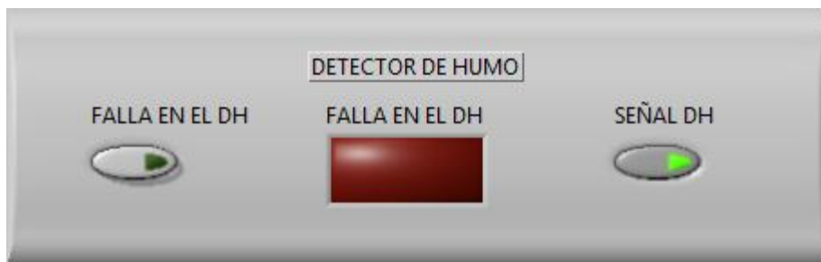
Figura 4.2 Interfaz gráfica del subsistema de detección de humo.
