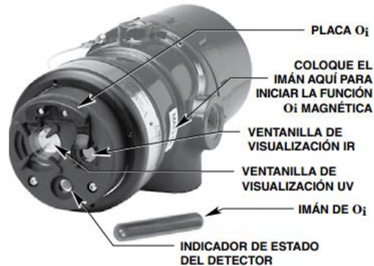
Figura 3.19 Detector de fuego UV/IR propuesto
