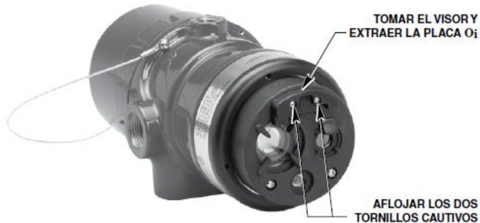
Figura 3.23 Extracción de la placa Oi.
