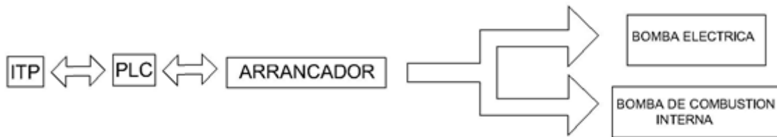
Figura 4.19 Diagrama de bloques de las bombas del paquete de presión balanceada
