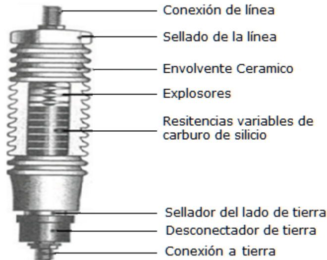
Figura 3.25 Esquema del apartarrayos de Carburo de Silicio.
