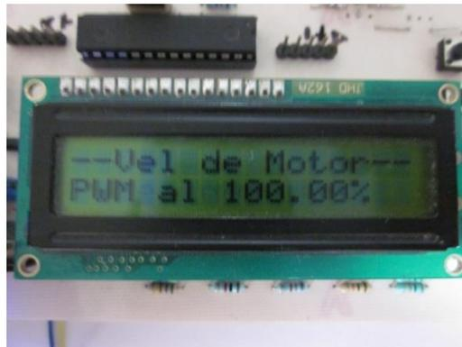
**Figura 5.14.** Interfaz en modo para variar la velocidad del motor.
