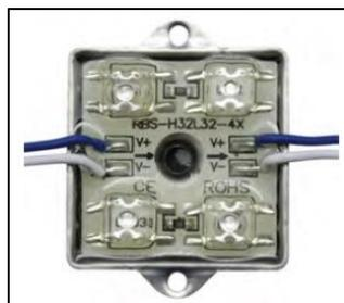
**Figura 2.13** Módulo LED color azul Modelo H32L32.
