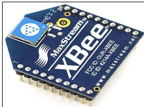
**Figura 2.3** Módulo XBee serie 1 de MaxStream.
