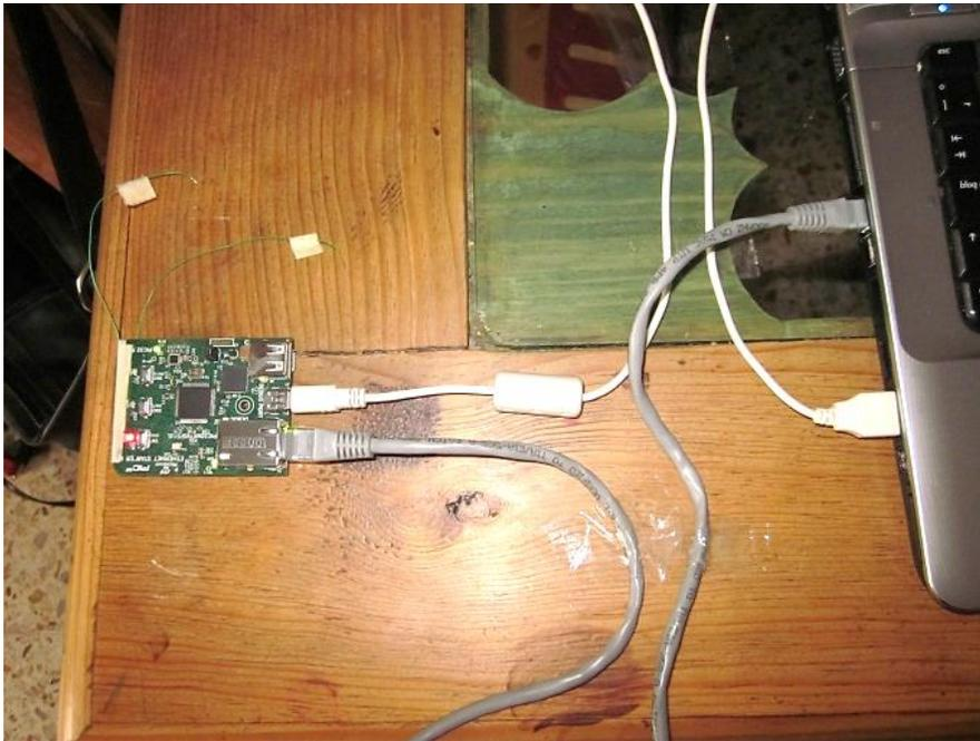
**Figura 5.1** Conexión de la tarjeta PIC32 a la PC.
