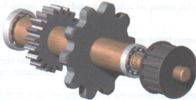
Figura 1.4.4 Eje soportando componentes de transmisión.
