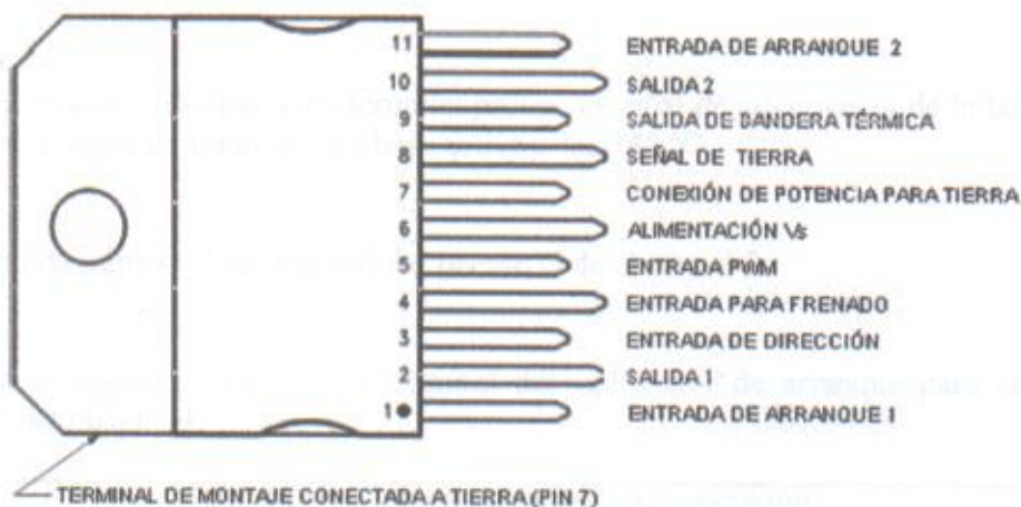
Figura 2.3.6 Circuito integrado LMD18200.
