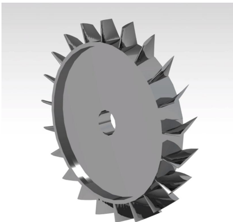
Fig. 3.7 Vista isométrica del rotor de la turbina.
