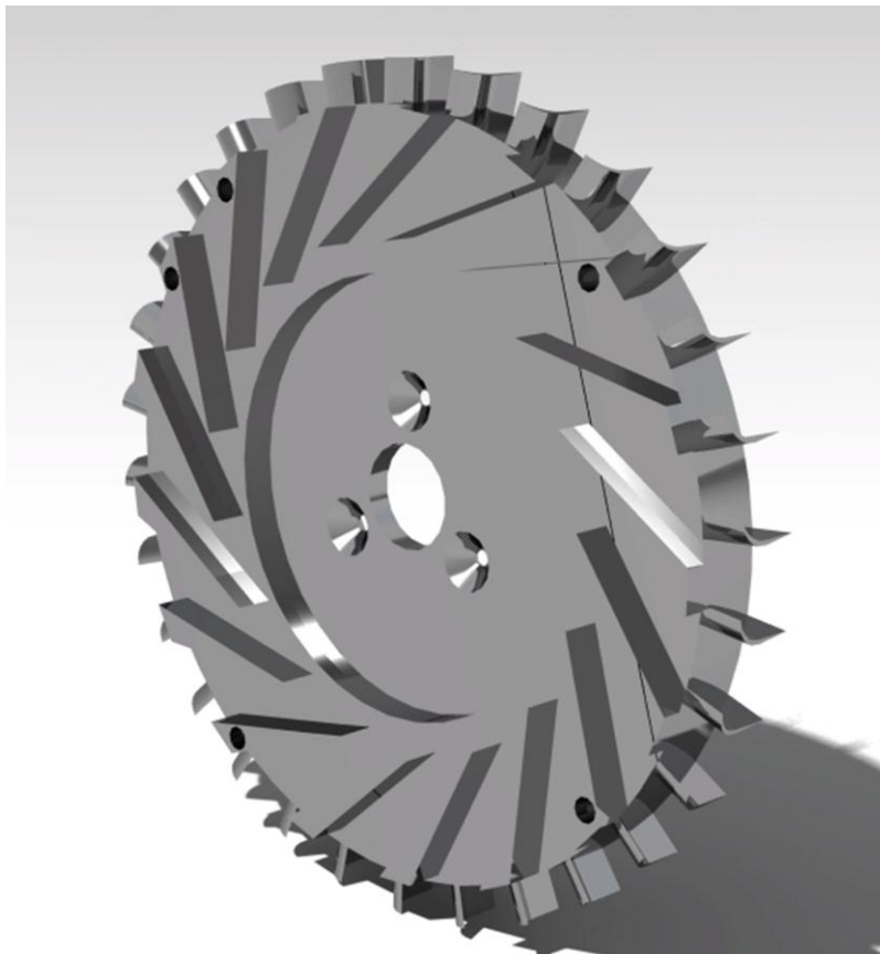
Fig. 3.4 Vista isométrica del estator del compresor.
