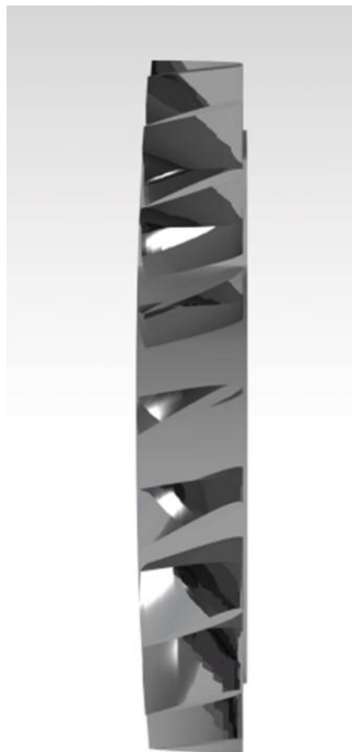
Fig. 3.9 Vista lateral del rotor de la turbina.
