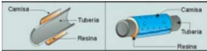
Figura 4.14 Camisa de protección para las tuberías
