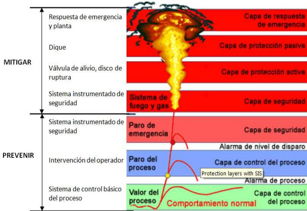
Figura 2.1 Implementación de las capas de protección. [11]
