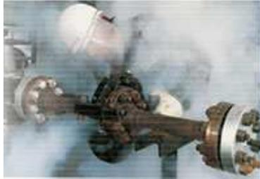
**Figura 3.16** Prueba de fuga en Brida [10]
