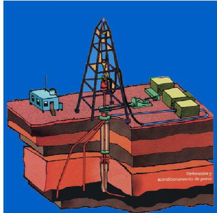
Figura 4.12 Perforación rotatoria aplicada en la extracción de gas natural. [23]
