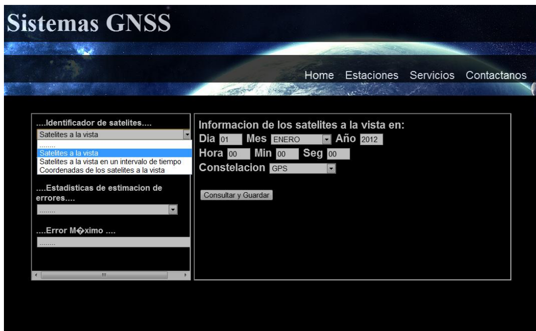
Figura 32. Opción de servicios, se realiza la consulta de satélites a la vista, donde el usuario introduce los datos para poder visualizar la información que le sea útil. La información a introducir será: día, fecha, año, hora, minutos, segundos y la constelación que se desea utilizar, posteriormente se deberá dar clic en consultar y guardar.
