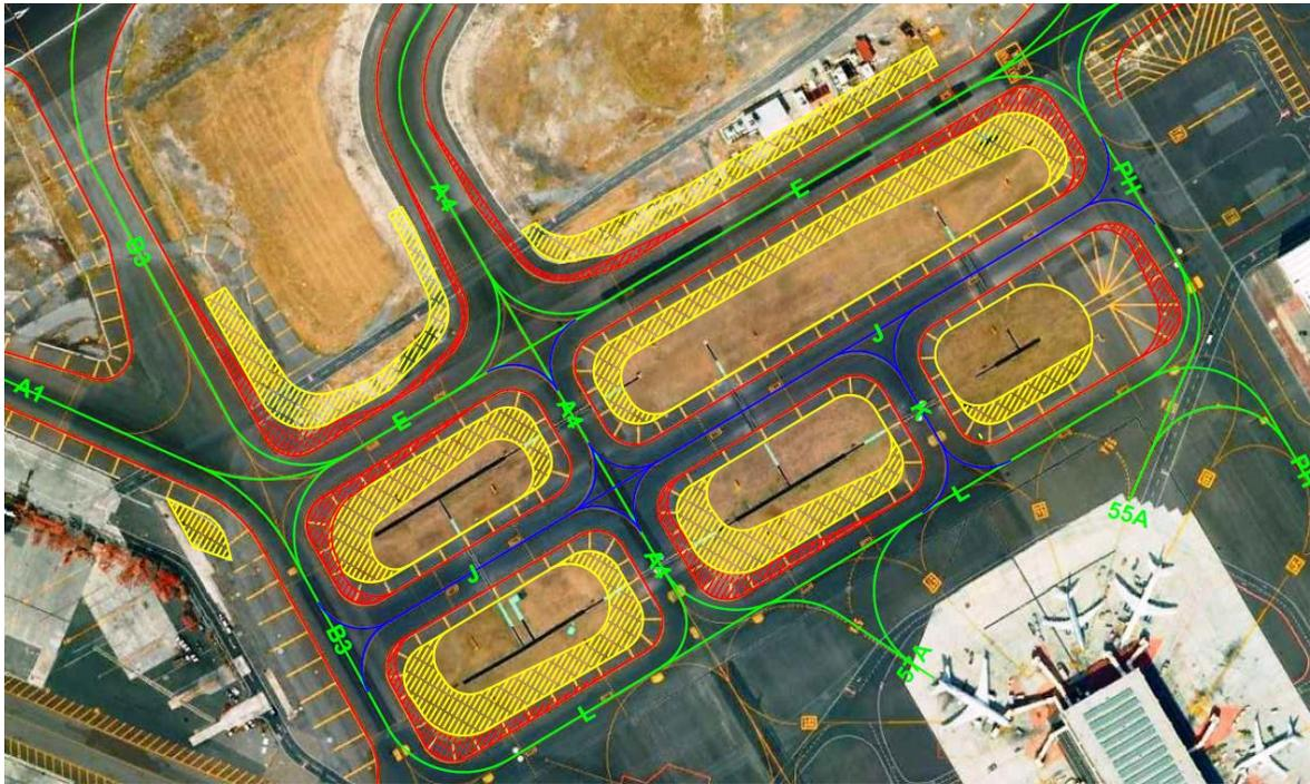
*Figura 78 "Calles de rodaje que permiten el arribo o el desalojo de las posiciones 55A y 57A de la terminal dos (T2)"*
