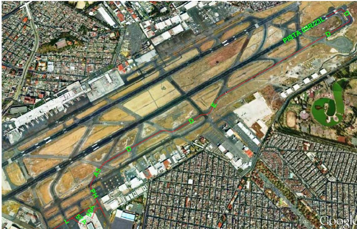
*Figura 94 "Ruta hacia el umbral de la pista 23L para efectuar un despegue saliendo de las posiciones 55A y 57A"*
