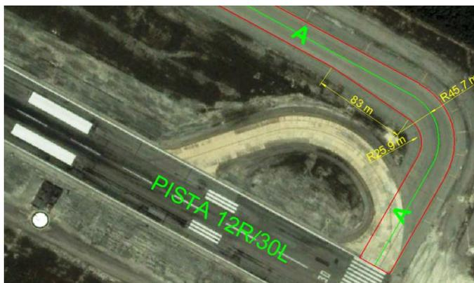
Figura 66 "Superficie de enlace del rodaje A que intersecta la pista 12R/30L en el umbral 30"
