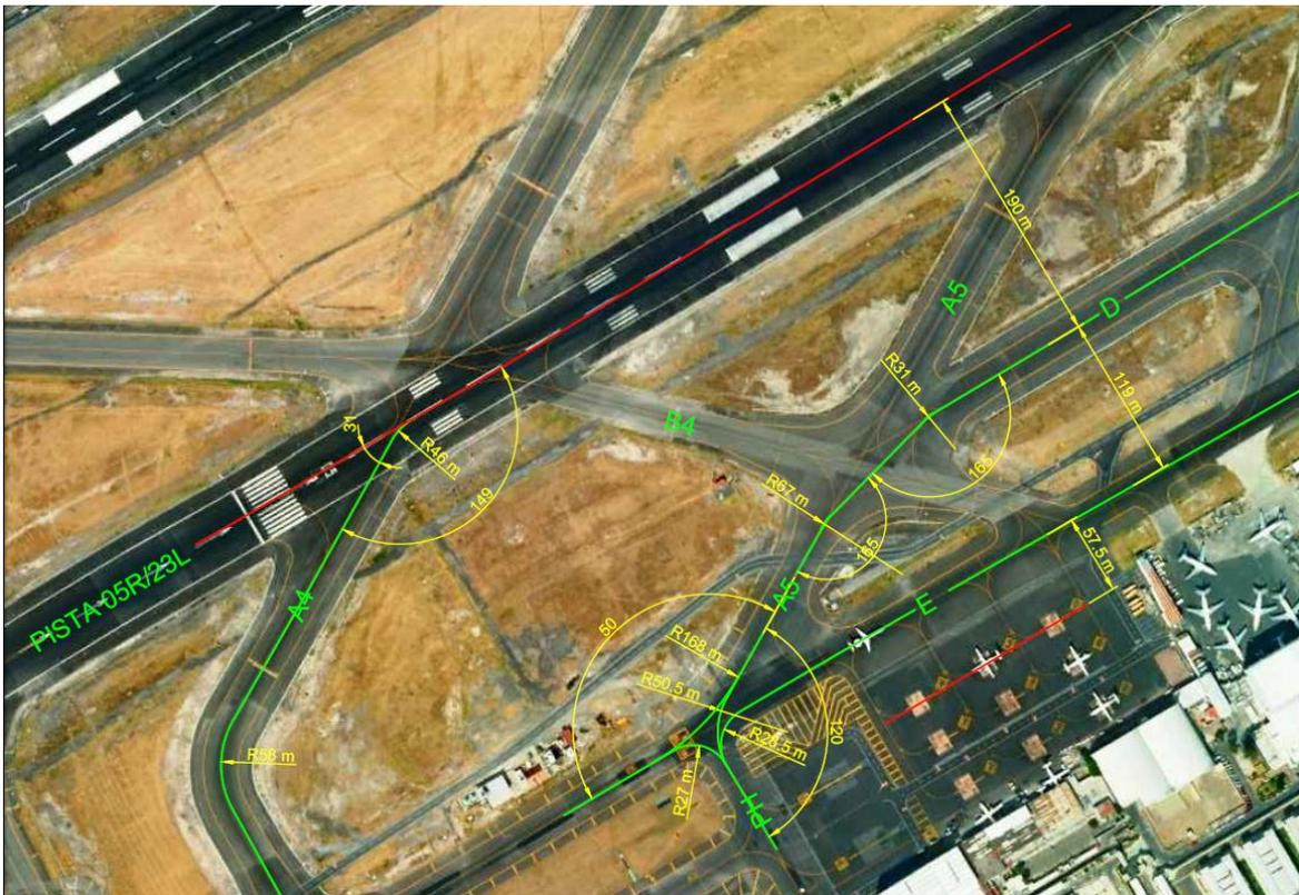
*Figura 29 "Separación de las calles de rodaje D y E con la pista, entre ellas y con objetos"*
