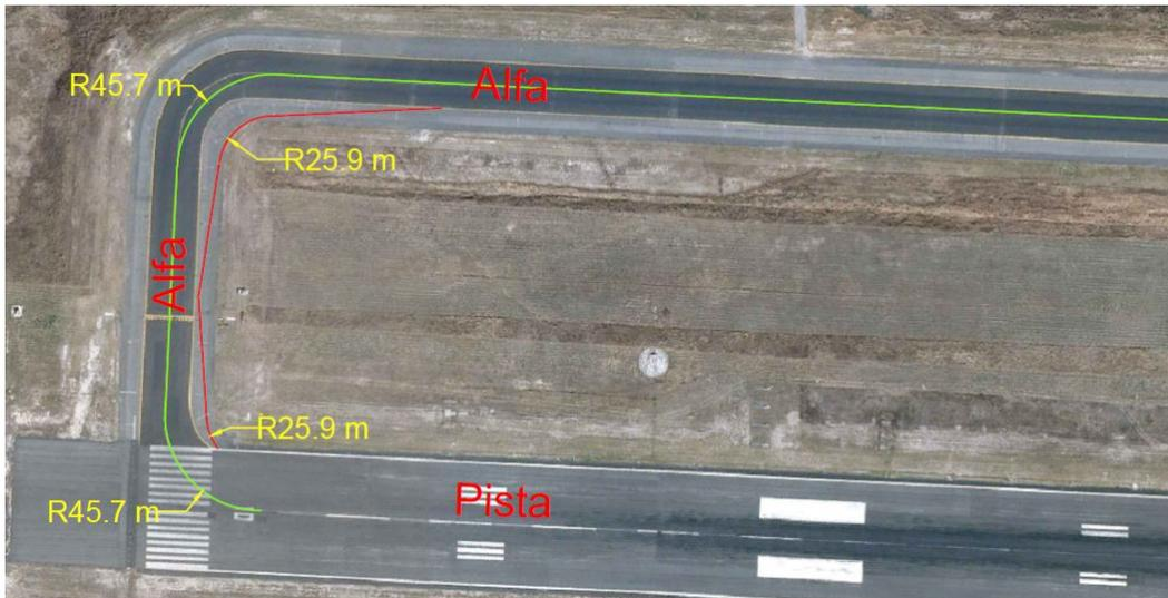
Figura 46 "Corrección de la curvatura de la señal de eje de rodaje de la pista 10/28 y el rodaje A"
