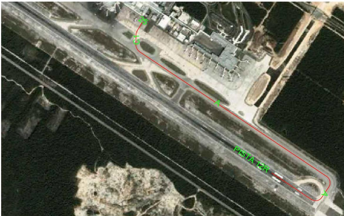
*Figura 98 "Ruta de arribo a la posición 25 desde el umbral 30L efectuando un aterrizaje por la pista 12R"*
