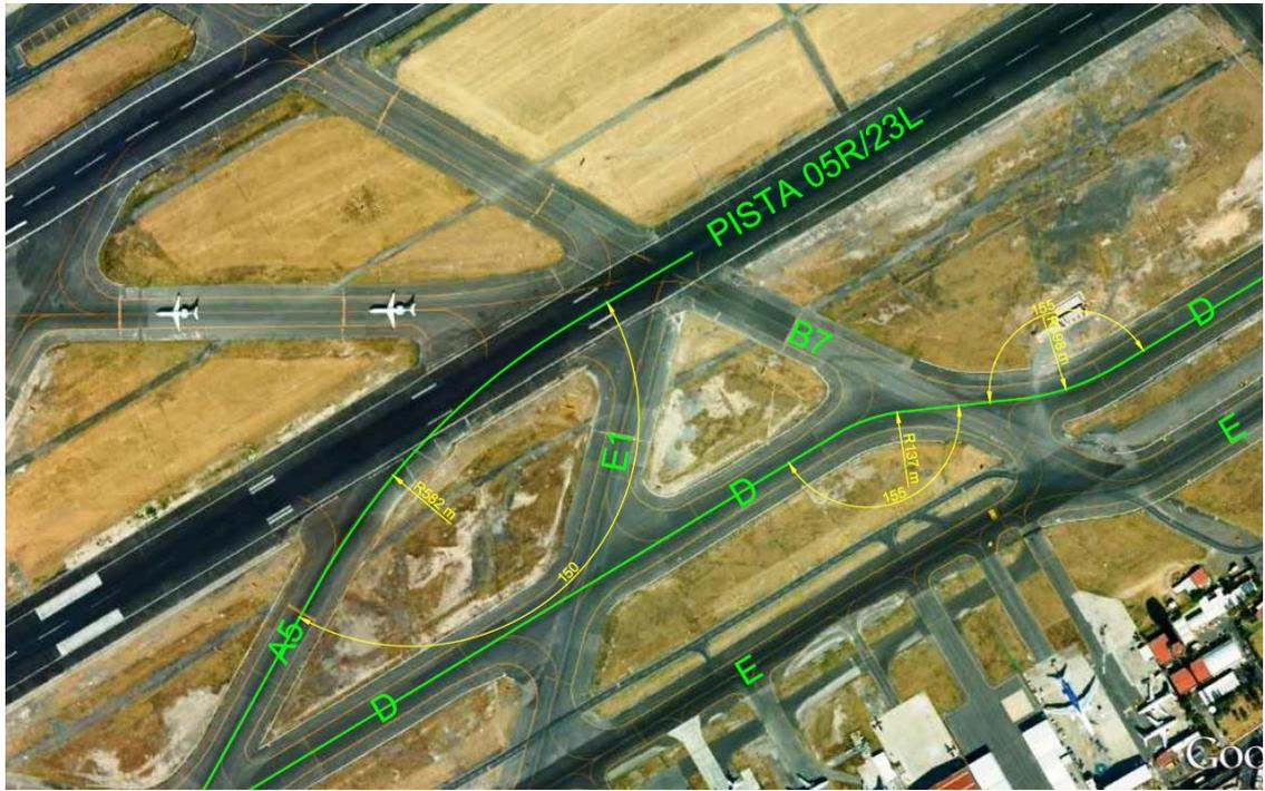
*Figura 40 "Dimensiones de las curvas que unen a las calles de rodaje entre E2 y A5"*
