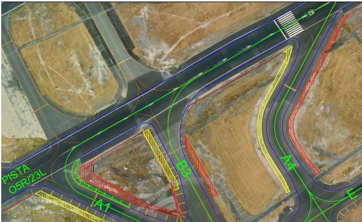
*Figura 79 "Calles de rodaje que permitirían el arribo o el desalojo del A380 de la pista 05R/23L"*
