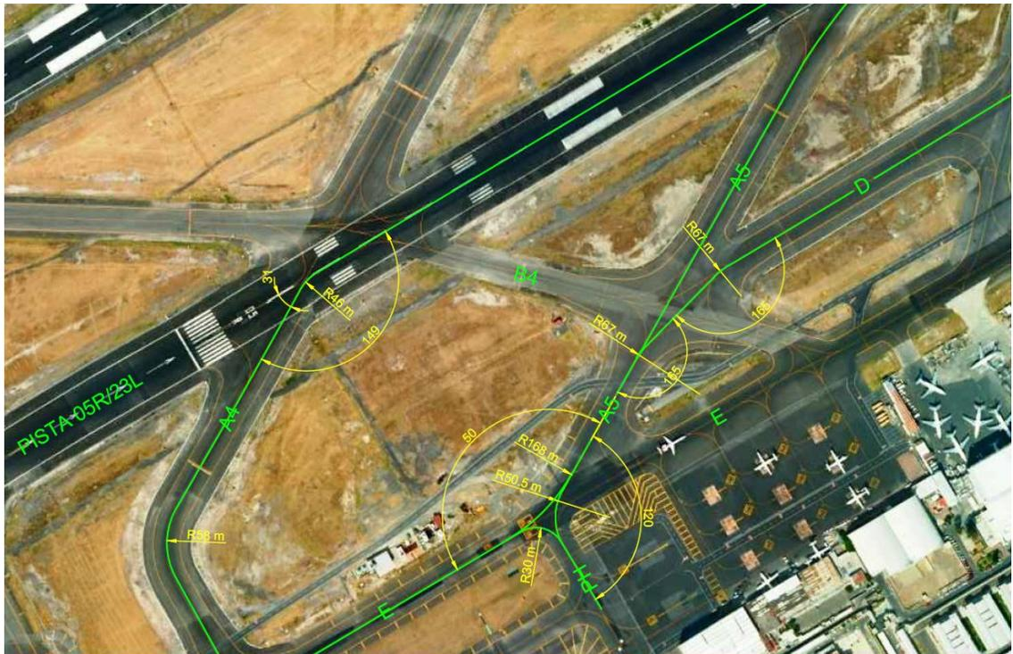
*Figura 41 "Dimensiones de las curvas que unen a las calles de rodaje entre A5, E y A4"*
