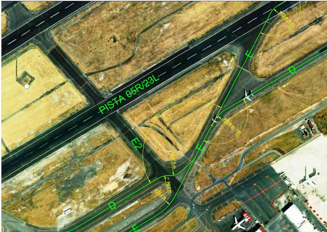
Figura 39 "Dimensiones de las curvas que unen a las calles de rodaje entre G y E2"
