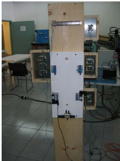
Figura D2. Vista posterior. Tablero de control neumático.
