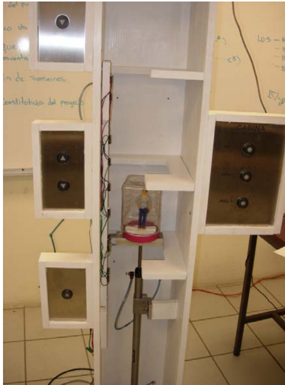
Figura 4.22 El elevador toca el sensor de alta velocidad de ascenso del primer nivel.
