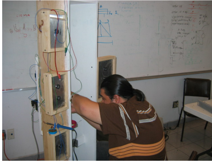
Figura D5. Operación de alambrado de micro-interruptores.
