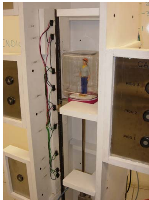
Figura 4.7 El elevador se encuentra en posición de zona de puertas del segundo nivel.
