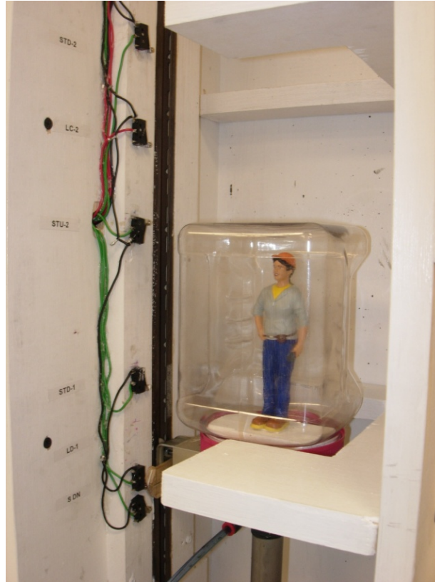
Figura 4.1 El elevador se encuentra en posición de zona de puertas del primer nivel.
