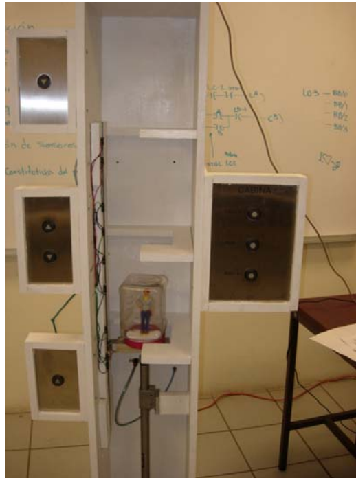
Figura 4.24 El elevador se encuentra en posición de zona de puertas del primer nivel.
