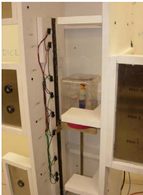
Figura 4.5 El elevador toca el sensor de alta velocidad de ascenso del segundo nivel.
