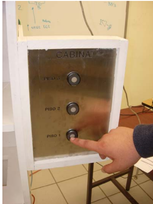
Figura 4.20 Se presiona el botón de cabina para descenso al primer nivel
