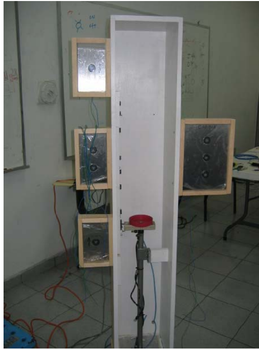
Figura D1. Vista frontal. Cilindro y botoneras de piso y cabina.
