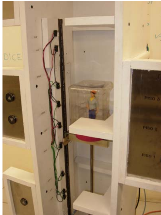
Figura 4.4 Al presionar el botón de cabina al segundo nivel se acciona las bobinas de ascenso.
