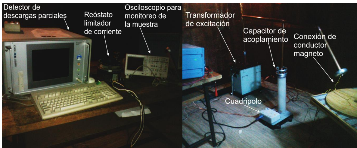
Figura 4.7. Circuito para medición de descargas parciales.
