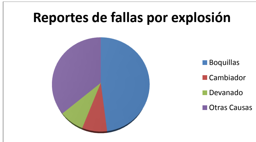
Gráfica 1.- Fallas de Transformadores que originaron Explosión con incendio 2000-2010 16
