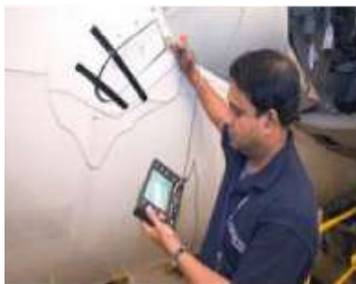
FIG 14 .7- Inspección por método de Corrientes Eddy.
