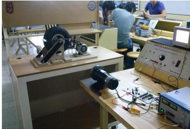
Figura 6.8 Prototipo en circuito impreso conectado al motor de CD 60 Volts @ 6.5 Amper.
