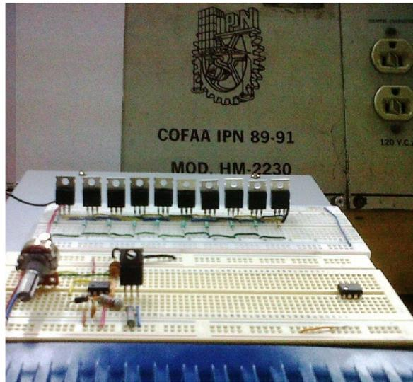
Figura 6.6 Prototipo de Interfase a nivel de protoboard para control de motor de CD 60 Volts @ 6.5 Amper, basado en transistores MOSFET.
