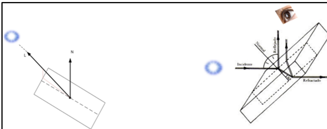
Fig. (3.7) Vectores asociados con el vector Normal (a) Vector L , Vector incidente (b) Vector R , Vector de reflexión
