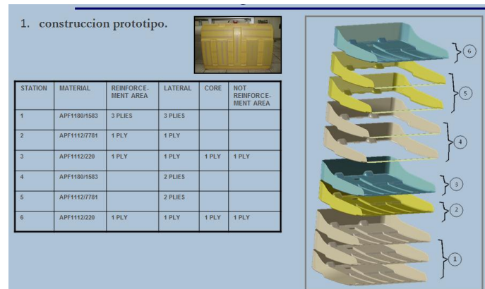
Fig. 65 Laminado prototipo de la guarda con fibra de vidrio y resina fenólica
