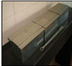
FIGURA 3.27a Quemador de tipo doméstico, con cajones separables.
