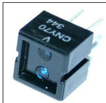
FIGURA 3.32 Sensor CNY70, emisor receptor infrarrojo.
