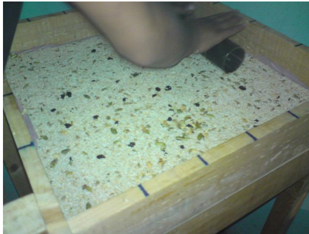
FIGURA 1.7 Compactación de la mezcla.
