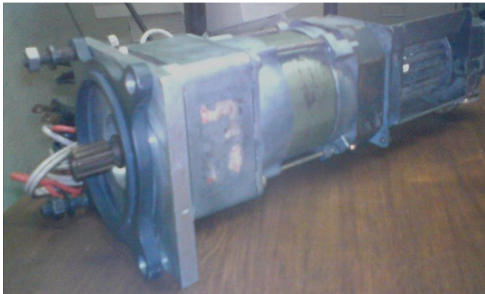
Figura 52. Ensamble del soporte y del motor eléctrico.
