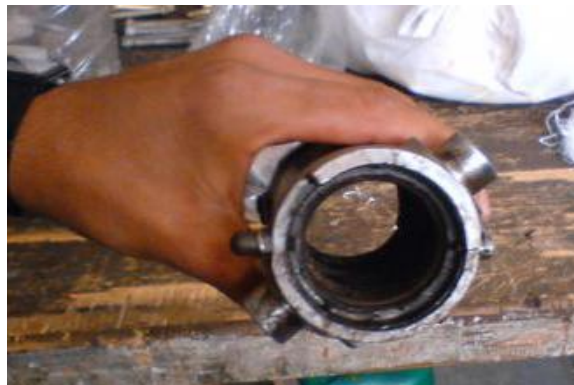
Figura 33. Limpieza de la caja Gimbal (vista frontal).
