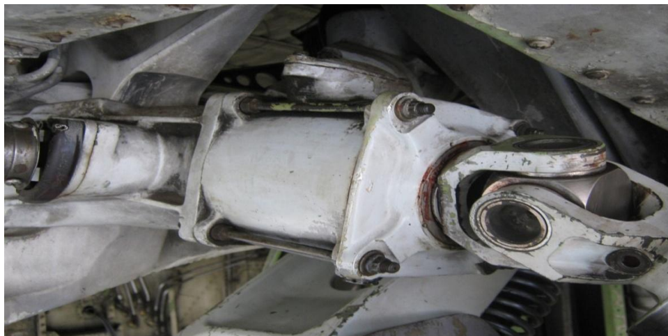
Figura 31. Caja de transmisión Flap No. 2.
