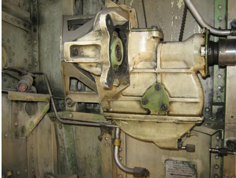
Figura 19. Caja de engranes de operación reversible de los Flaps.
