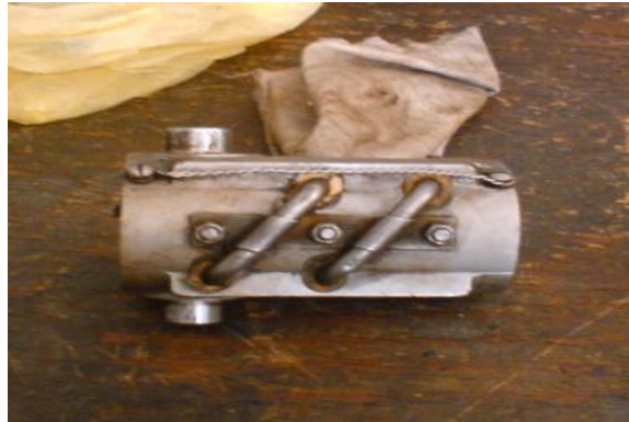
Figura 33. Limpieza de la caja Gimbal (vista superior).
