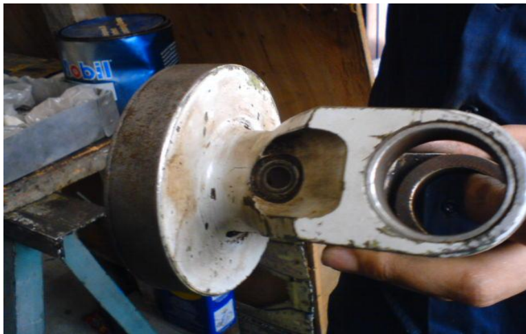
Figura 37. Servicio a las crucetas del Flap No 2.
