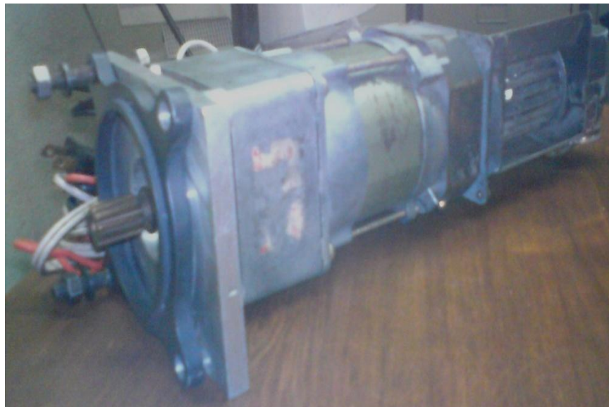
Figura 60. Motor eléctrico monofásico de A.C.
