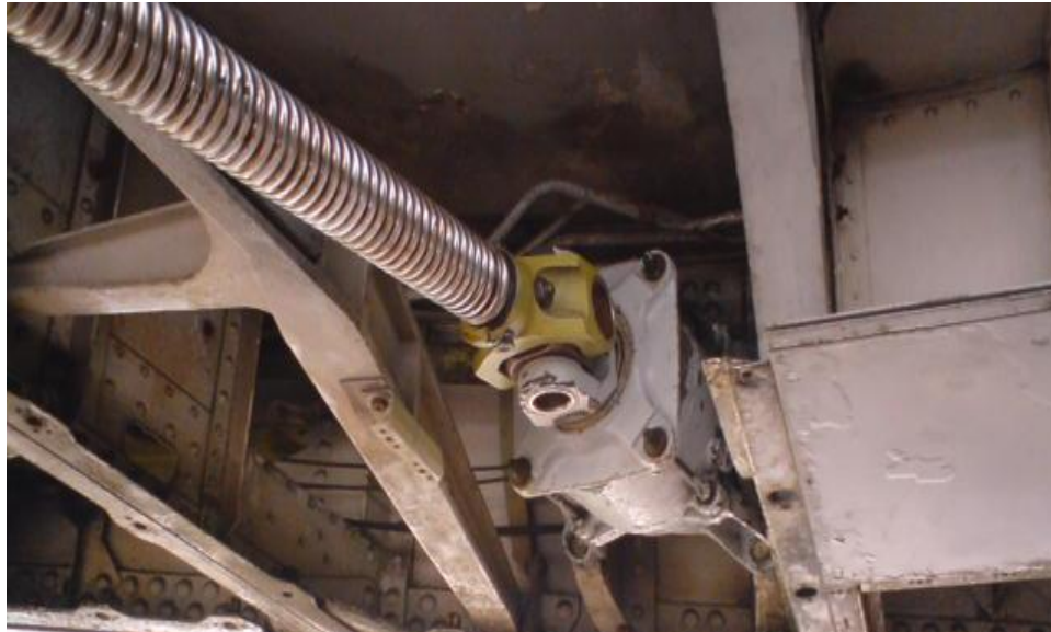
Figura 36. Ejemplo ensamble del Flap No. 2 a la aeronave Boeing 727-200.
