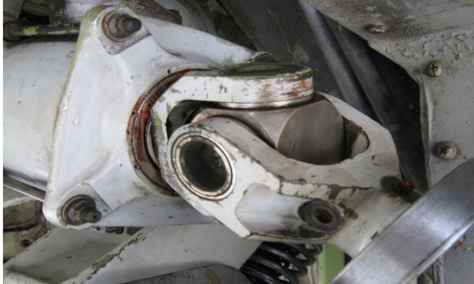
Figura 40. Ensamble de las crucetas de la aleta hipersustentadora interna No.2 de la aeronave Boeing 727-200.
