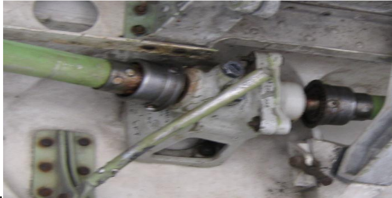
Figura 18 Unidad de transmisión de ángulo de los flaps interiores.
