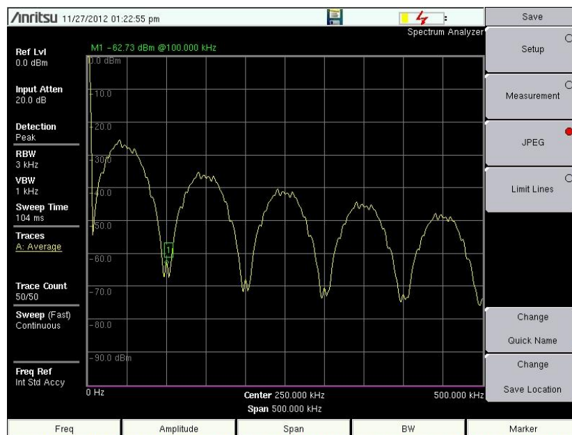
Figura 4.64 Espectro de código AMI, T_b = 10 mili segundos – Analizador de espectros.
