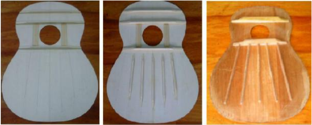
Figura 2: Placas armónicas utilizadas en trabajo experimental: placa Oporto sin barraje (I), placa Oporto con sistema de barraje Torres (II) y placa Santana (III).
