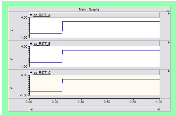
Figura 61. Operación por falla trifásica interna.
