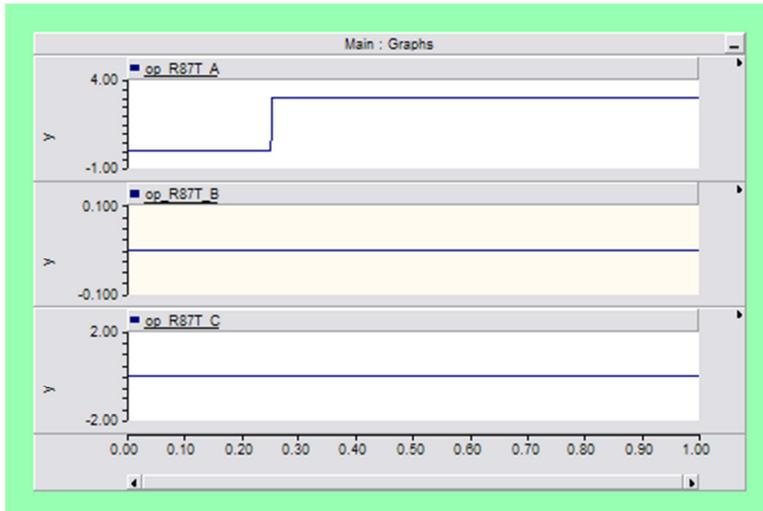
Figura 58. Operación por falla monofásica interna.
