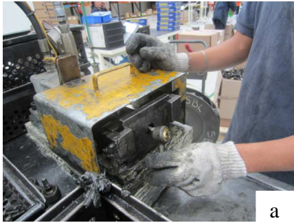
Figuras 3.5.1.1 a) Maquina de prueba para stud pull out; b) Colocación de la conexión de la barra estabilizadora.
