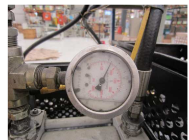
Figuras 3.5.1.3 a); b) Se muestra la destrucción del conjunto al separar la rótula de su carcaza; c) Carátula donde se obtiene la medición, resultado de la prueba.
