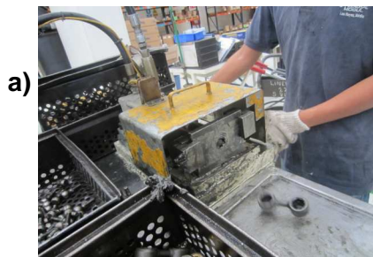
Figuras 3.5.1.3 a); b) Se muestra la destrucción del conjunto al separar la rótula de su carcaza; c) Carátula donde se obtiene la medición, resultado de la prueba.
