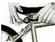
El asiento puede desplazarse hacia atrás y hacia adelante para conseguir la posición correcta del pie sobre el pedal y mejorar la cadencia en el pedaleo.
