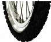
Para calles empedradas, pavimentos en mal estado, o terracerías, el ancho de la llanta soporta los golpes. Tiene agarre en las curvas y en terrenos resbalosos, aunque son lentas en la ciudad.
