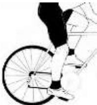
El asiento debe estar colocado a una altura en la que, apoyado en el pedal, se extiendan las piernas en 90%. La altura correcta del asiento permitirá tener un pedaleo eficiente y cómodo. Es necesario colocarse de pie a un lado de la bicicleta, y poner el asiento a la altura de la cadera.
