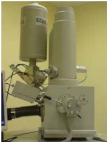
Figura 2.2. Microscopio Electrónico de Barrido acoplado a un Espectrómetro de Energía Dispersada de Rayos X.
