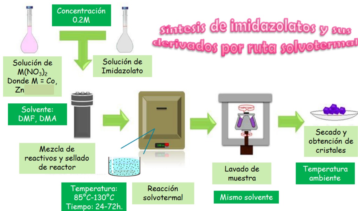
Figura 5.1. Desarrollo experimental para la obtención de imidazolatos y sus derivados por ruta solvotermal.
