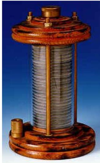
Fig. 1.3 Pila de Alessandro Volta [Encarta, 2008].
