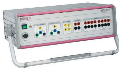
Figura 3.8 Fuente de alimentación en CA marca Kocos 300. [22]
