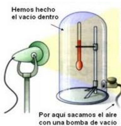
Figura 2. 5. Transferencia de calor por radiación.
