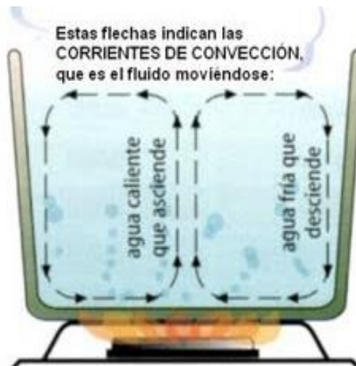
Figura 2. 4. Transferencia de calor por convección.
