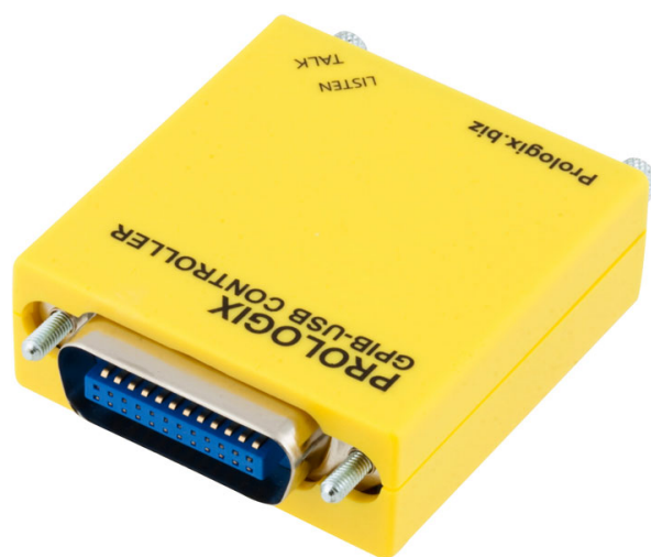
Figura 5.5: Vista frontal del adaptador GPIB a USB Prologix
