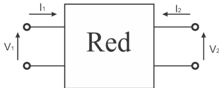
Figura 2.3: Representación de un cuadripolo con sus correspondientes corrientes y voltajes
