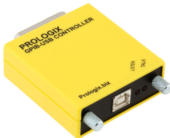
Figura 5.6: Vista trasera del adaptador GPIB a USB Prologix
