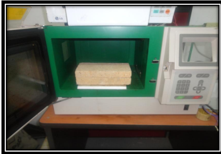
Figura 24. Sistema de separación por microondas con contenedor de alúmina.
