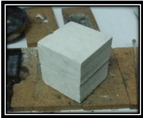
Figura 25. Contenedor refractario de caolín y tergopor [52]
