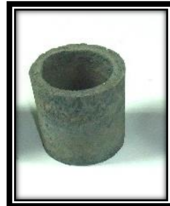
Figura 26. Contenedor de carburo de silicio. [52]
