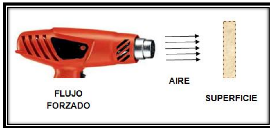
Figura 6. Transferencia de calor por convección forzada [40]
