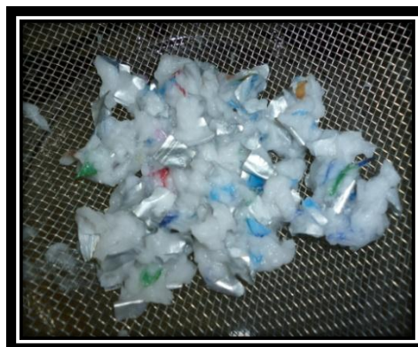
Figura 35. Cribado de la pulpa separada del envase multilaminado.
