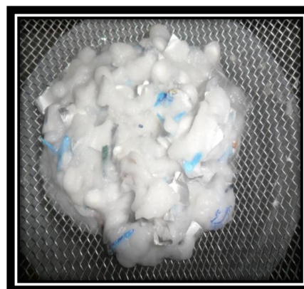
Figura 33. Cribado de la pulpa separada del envase multilaminado.
