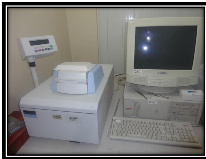
Figura 9. Calorímetro diferencial del barrido
