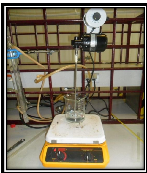
Figura 15. Sistema de agitación con 3 aspas.
