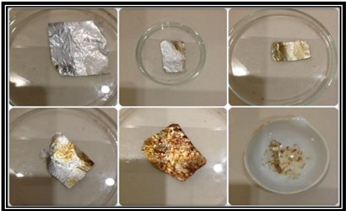
Figura 46. Oxicación de polietileno al aplicar calor al filme de p-p-a-p.
