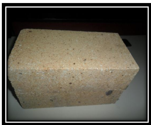
Figura 23. Contenedor refractario de alúmina.
