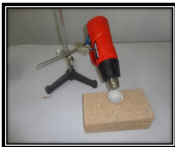
Figura 18. Sistema de emisión térmica directamente en la muestra.
