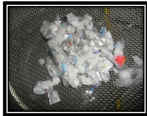
Figura 31. Cribado de la pulpa separada del envase multilaminado.
