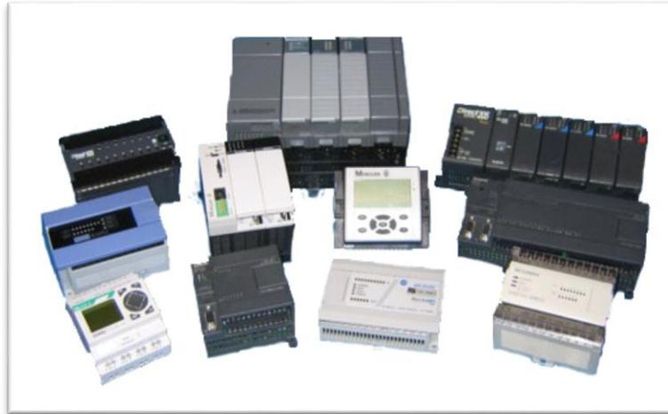
*Figura 1. 15 PLC'S De diferentes marcas*
