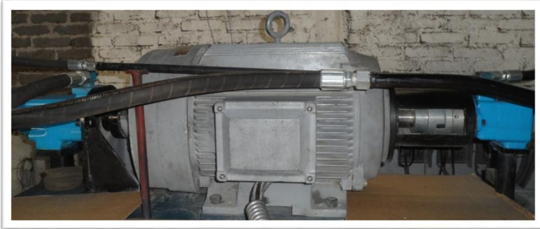
Figura 3. 16 Coplee de motor y b bombas
