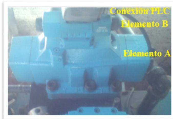
*Figura 3.8 Acoplamiento de Válvulas direccionales*
