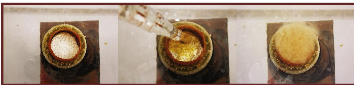
Figura 21. Esquema de las etapas de la aplicación de los tratamientos de conversión.
