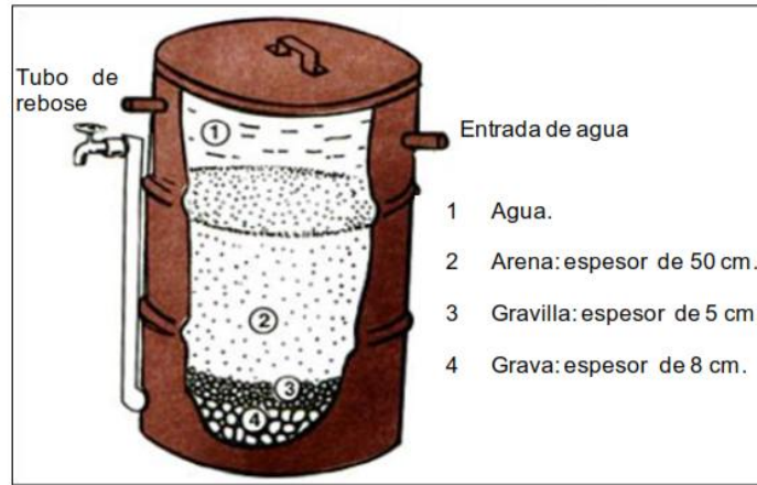
Figura 3. 7 Filtración lenta en arena
