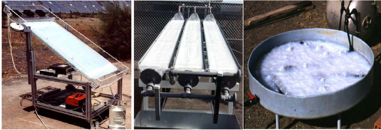
Figura 15. Izquierda: captador solar estático de placa inclinada (cerrada) con catalizador ( \text{TiO}_2 ) soportado, PSA. Centro: prototipo de captador tubular (National Renewable Energy Laboratory, USA). Derecha: colector tipo balsa superficial, PSA.
