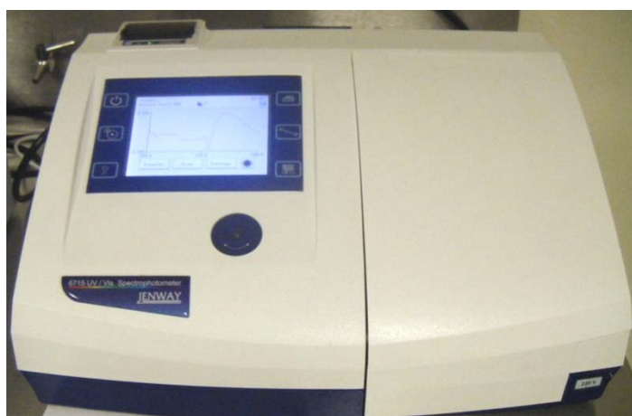
Figura 23. Espectrofotómetro de UV-Vis Jenway 6715
