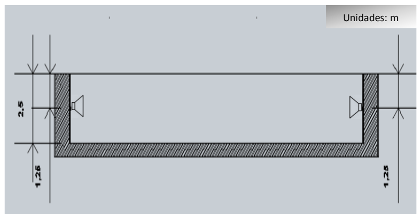
Figura 3.9 Vista de la distribución de los altavoces en plano de planta
