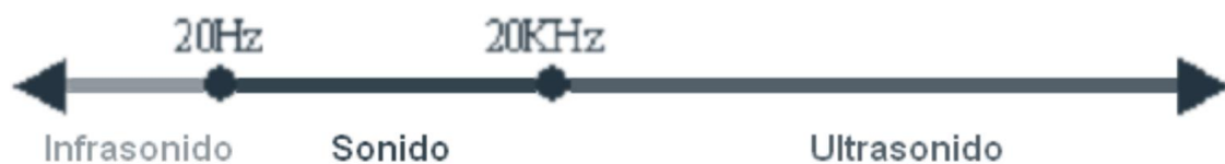
Figura 2.6 Fronteras de infrasonido, sonido y ultrasonido
