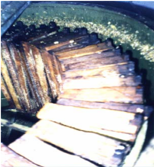
Fig.3.18 Se colocan las alzas o cuadros con los residuos de miel para extraer la miel aplicando fuerza centrífuga.
