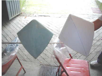
Imagen 7.5. Molde de las esquinas. La pieza que está a la derecha aún no tiene capa protectora
