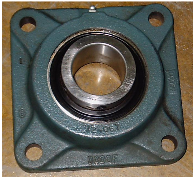
Figura 2. Cojinete montado en la caja de chumacera vertical. Imagen tomada con fines didácticos [ref. 2 ]
