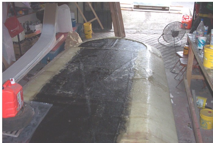
Imagen 7.19. Unión de la carcasa con el piso.
