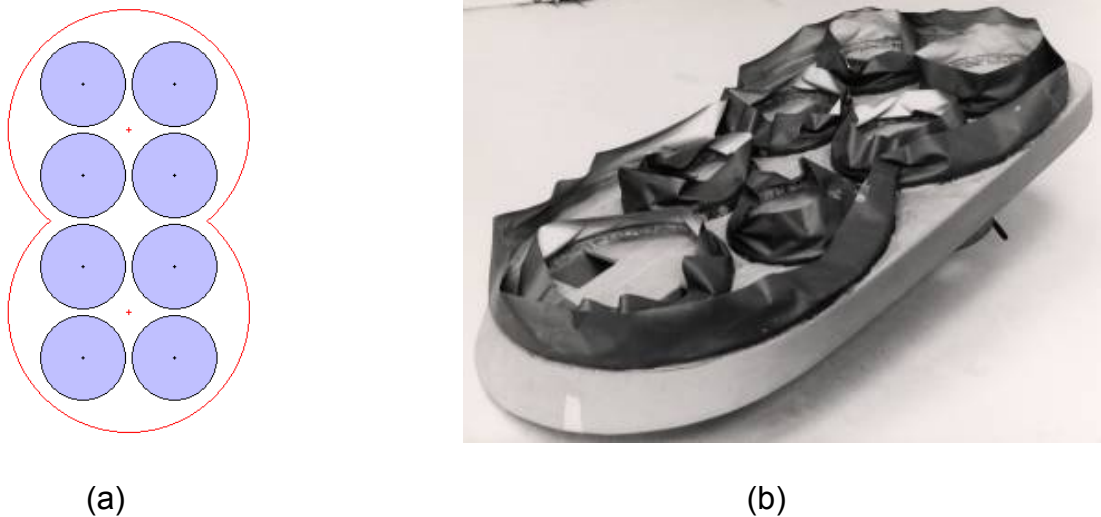
Figura 5.3. Conjunto de 8 faldas elementales envueltas por una falda periférica (a). Modelo provisto de un sistema multi-faldas y provisto de una falda periférica (b).
