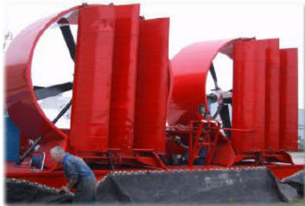
Figura 4.7 Vehículo de colchón de aire el cual está provisto de este tipo de timones de dirección. Tomada con fines didácticos.[ref. 3 .]
