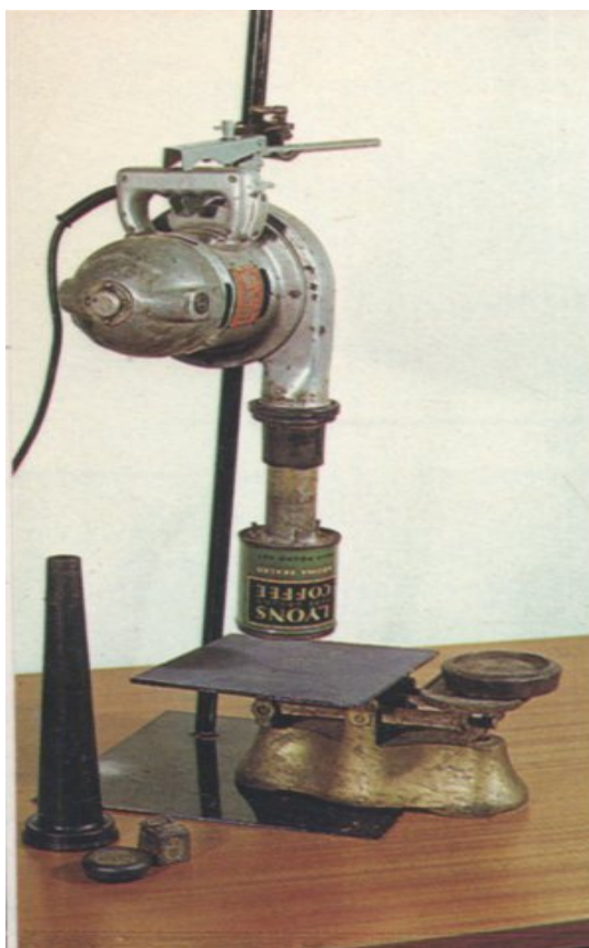
Figura A.1. Muestra el arreglo del experimento de Cockerell demostrando el principio de la cámara plena y corriente de chorro perimetral. Tomada con fines didácticos. [ref. A1 ]
