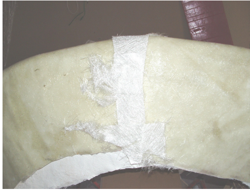
Imagen 7.9. Unión de la curva frontal de dos piezas hechas en fibra de vidrio
