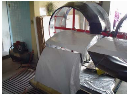
Imagen 7.42. Toberas traseras con una aplicación de GelCoat gris.
