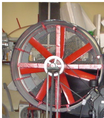
Imagen 7.1. Muestra el ventilador TAT-1000H alojado en la tobera.
