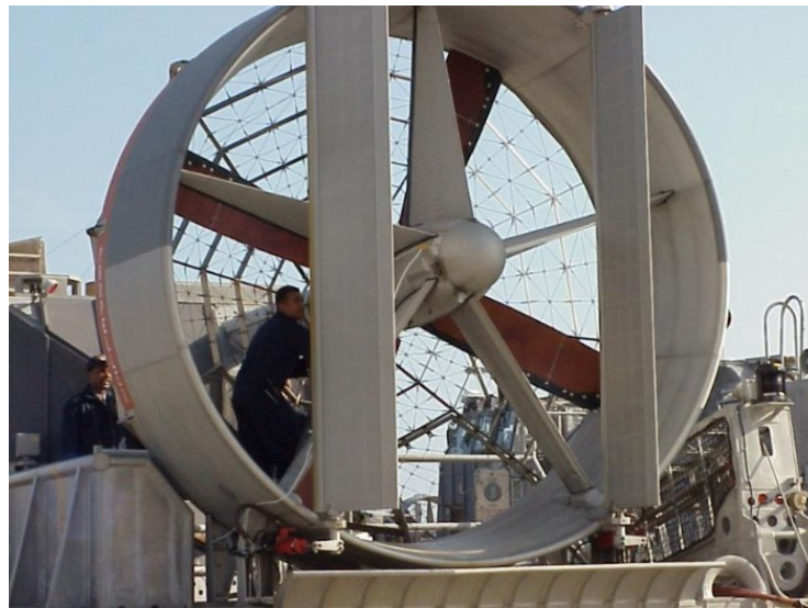
Figura 4.12. Hélice de paso variable en el vehículo LCAC-91. Tomada con fines didácticos. [ref. 6 ]
