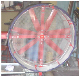
Imagen 7.13. Colocación de rejilla de protección
