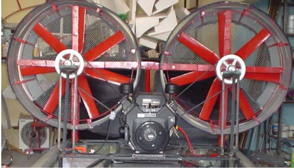
Imagen 7.43a. Muestra la colocación de los ejes de los ventiladores, poleas, bandas así como el motor en su base correspondiente.
