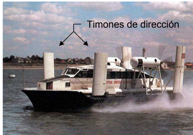
Figura 4.5 El vehículo VA 3 ejemplifica el uso de estos timones como medio de control. Tomada con fines didácticos. [ref 1 .]
