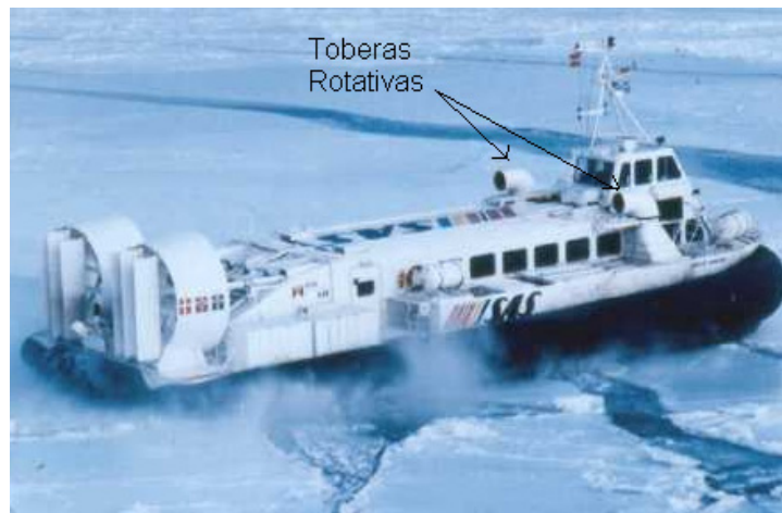
Figura 4.17. Vehículo con Toberas rotativas. Tomada con fines didácticos. [ref. 8 ]
