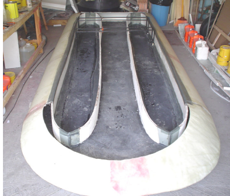
Imagen 7.22. Colocación de volúmenes de flotación.
