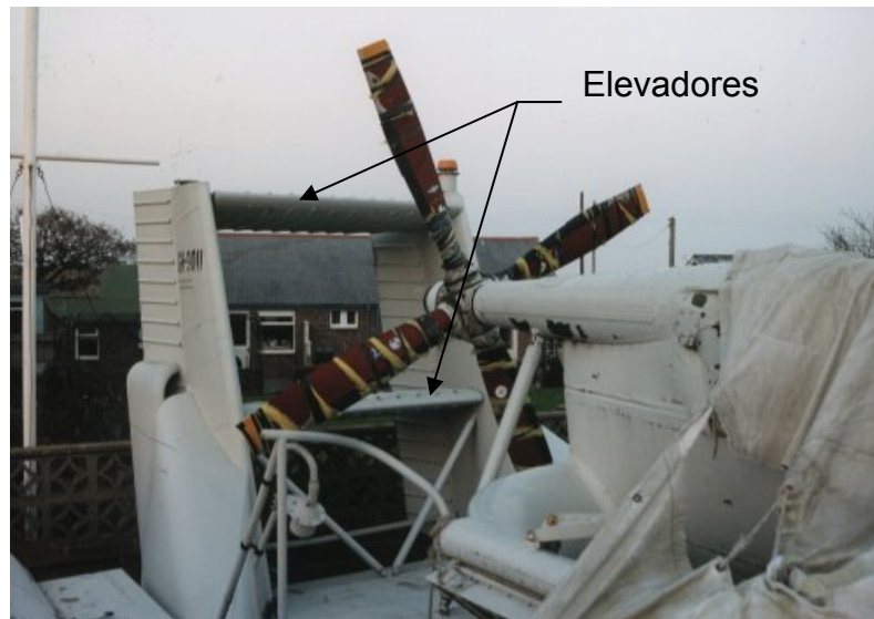
Figura 4.8. Vehículo de colchón de aire SR.N6 el cual tiene un par de elevadores. Tomada con fines didácticos. [ref. 4 ]
