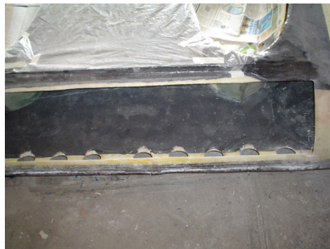
Imagen 7.37. Corte de la parte trasera de la carcasa donde va instalada la tobera trasera.
