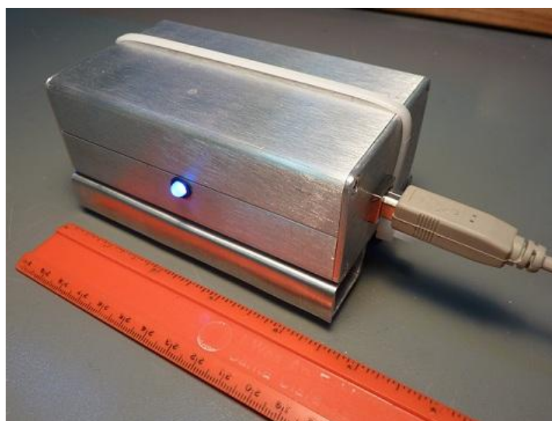
Figura 3.7 El sensor en una caja de aluminio con un LED que muestra a través de la parte superior de una mesa de nivelación pequeño. La luz es azul. Así que ha de detección de la gravedad en el eje Z.
