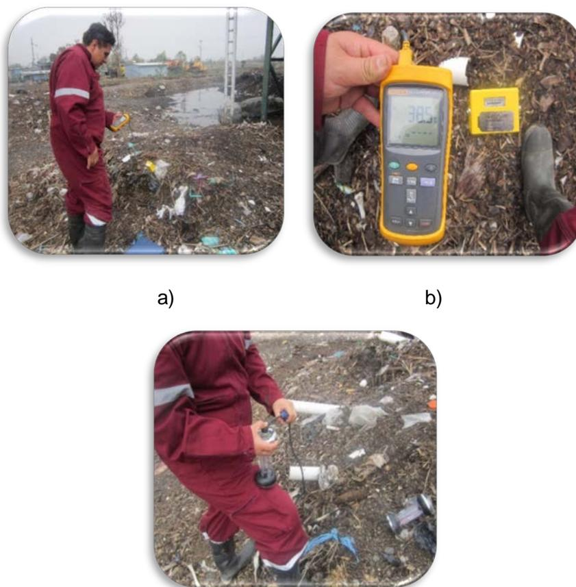
Figura 22 Medición de los parámetros de campo. a) Temperatura, b) Temperatura y Humedad y c) Oxígeno y Dióxido de Carbono.
