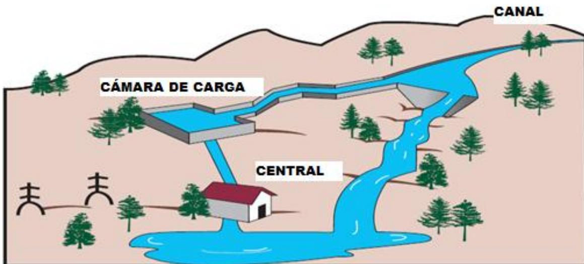
Figura 1.5 Central Hidroeléctrica de Agua Fluyente [1].
