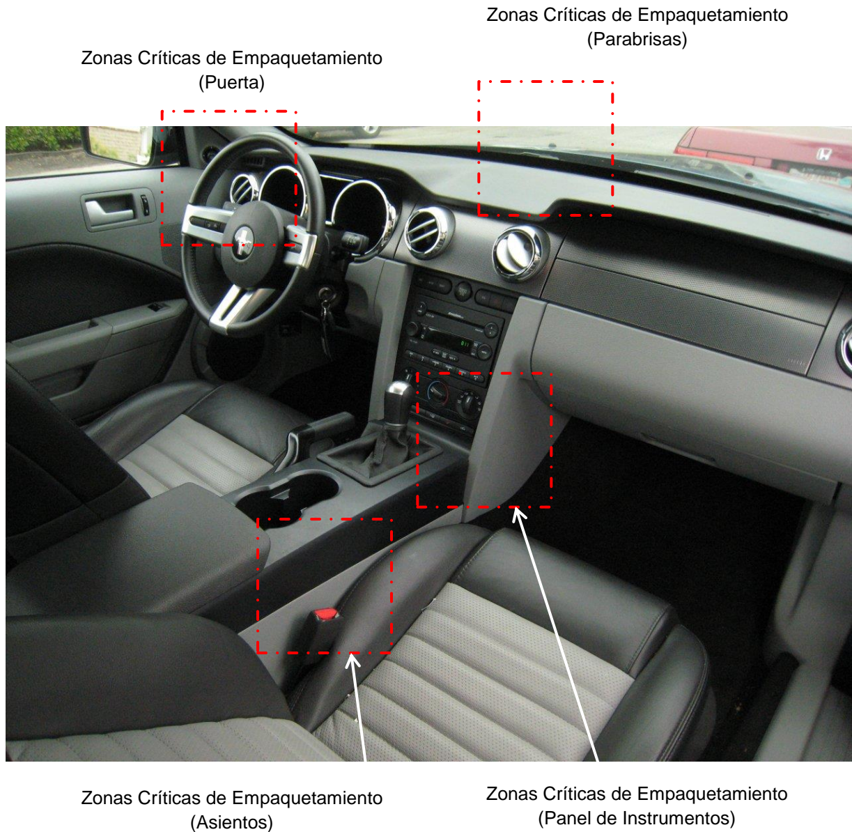
Figura 3.1 – Muestra zonas que son críticas en el diseño del panel de instrumentos y consola de nuevos modelos automotrices de Ford Motor Company
