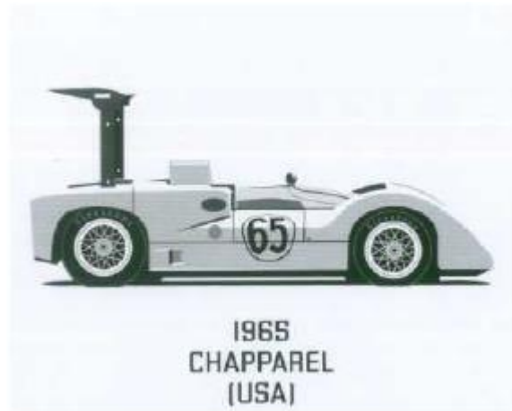
Figura 13 – Vista lateral del primer automóvil en emplear un ala para generar down force
