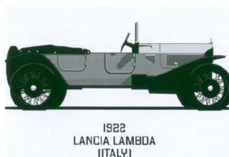
Figura 5 – Vista lateral del primer automóvil construido con un chasis monocasco
