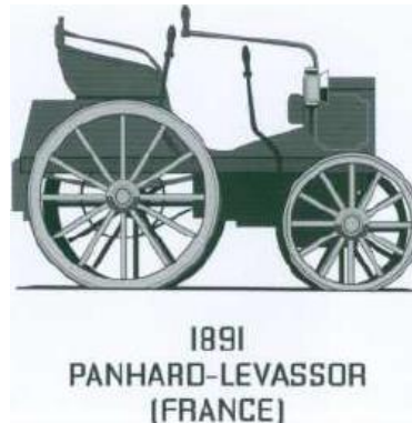
Figura 2 – Vista lateral del primer automóvil con la disposición de motor frontal
