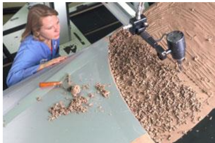
Figura 5.1 – Muestra cómo se realiza el proceso de diseño para la creación de modelos en arcilla, método aun empleado en muchas de las compañías automotrices
