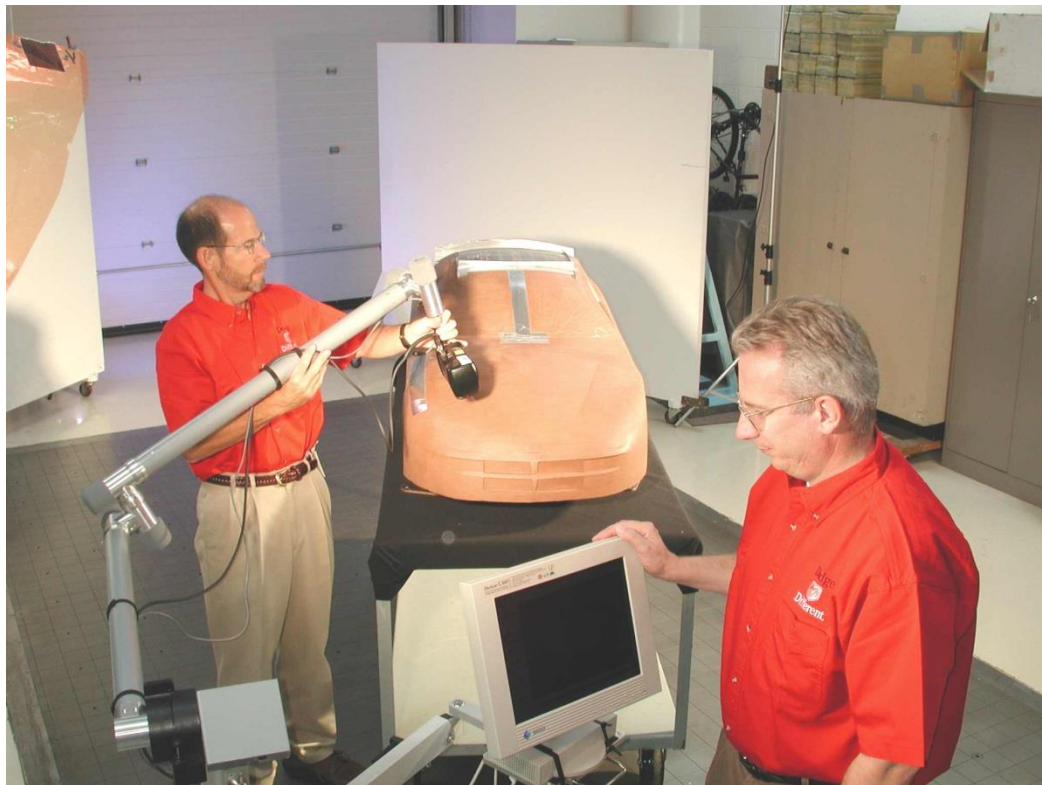
Figura 6.4 – Muestra un ejemplo de cómo es recabada la información de las nuevas superficies, posteriormente esta propuesta es digitalizada y analizada
