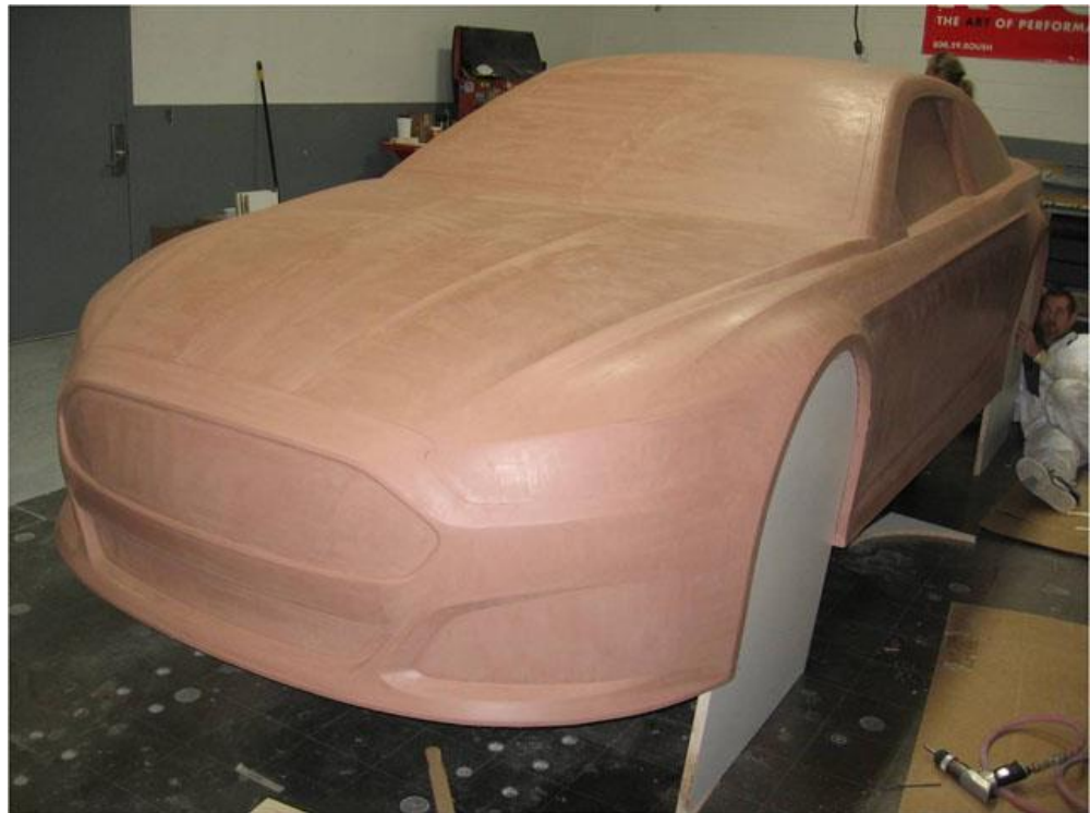
Figura 6.2 – Muestra algunos de los modelos automotrices de Ford Motor Company que fueron desarrollados en arcilla y actualmente son modelos que están en comercialización
