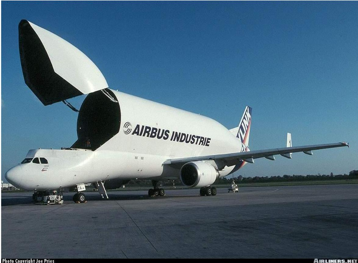
Esta es la clase de avión diseñado para transportar carga de grandes dimensiones. Si se necesita transportar un helicóptero o incluso un avión, se necesita un Súper Transportador.
