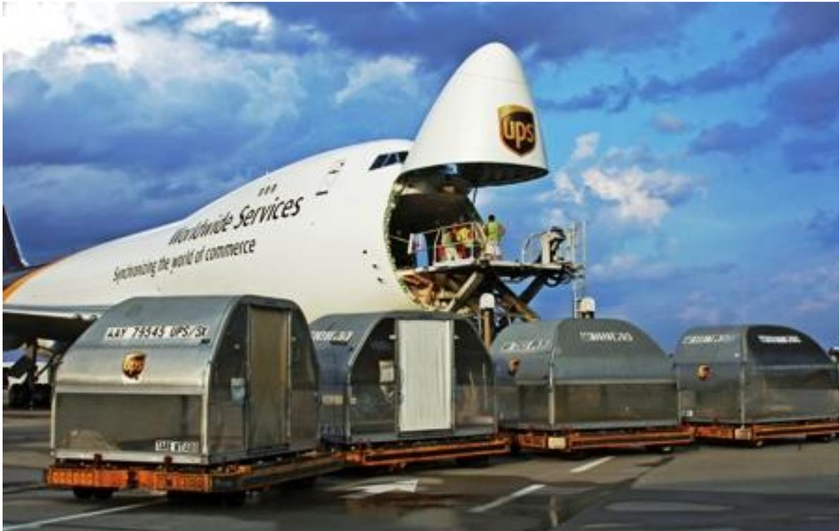
Diseñado como un avión de carga, el Boeing 747F tiene el suelo de cabina reforzado y poco se parece al Boeing 747 de pasajeros estándar.
